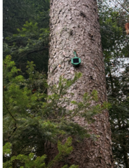
Die kleinen Sensoren mit Solarpanel hängen an ausgewählten Bäumen auf dem Sommerberg.
